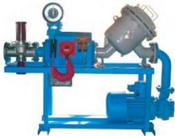
Счетно-дозировочный комплекс СДК-01 предназначен для измерения объема и коммерческого отпуска заданной дозы нефтепродуктов при перекачке, сливе, наливе. В состав комплекса входят: электронасосный агрегат, фильтр, счетчик, устройство заземления автоцистерн, электромагнитный двухкаскадный клапан, кнопка «пуск-стоп», датчик уровня, шкаф управления, пульт управления. Дополнительное оснащение: обратный клапан, устройство верхнего налива нефтепродуктов в автоцистерны (АСН-100А или АСН-80-02).
