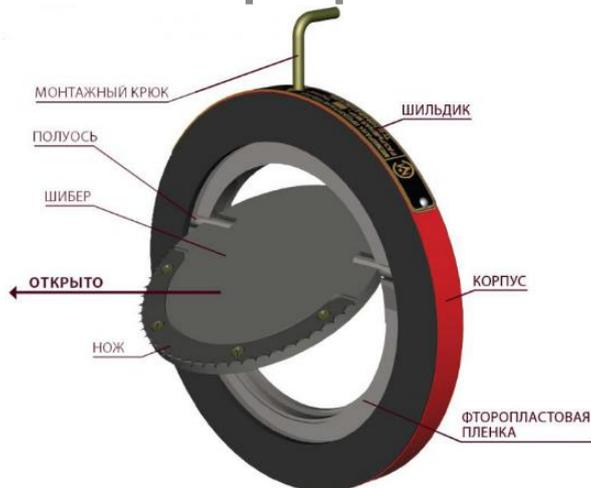
Предохранительная разрывная мембрана МПР предназначена для герметизации участка трубопровода, соединяющего резервуар с обратным клапаном и высоконапорным пеногенератором. Роль герметизирующего элемента в этой конструкции выполняет тонкая (0,15 мм) фторопластовая пленка, установленная между фланцем трубы и собственно корпусом предохранительной разрывной мембраны.
