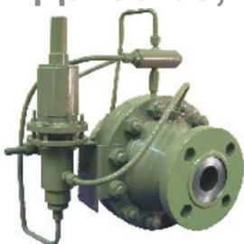
Регуляторы давления газа РДУ одноканальные, статические, прямого действия, работающие без использования постороннего источника энергии предназначены для автоматического регулирования давления газа "после себя" на объектах магистральных газопроводов высокого давления (газораспределительных станциях, установках очистки и осушки газа, газовых промыслах и др.).
