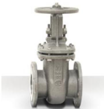
Стальные клиновые задвижки предназначены для установки на трубопроводах в качестве запорного устройства. Корпусные детали задвижек изготавливаются из стали марок: 35Л, 20ГЛ, 12Х18Н9ТЛ, с фланцевым присоединением и под приварку, с ручным управлением (с маховиком, механическим редуктором) или исполнением под электропривод. Класс герметичности «А» по ГОСТ 9544-2005. Срок службы не менее 10 лет. Гарантия 24 месяца.
