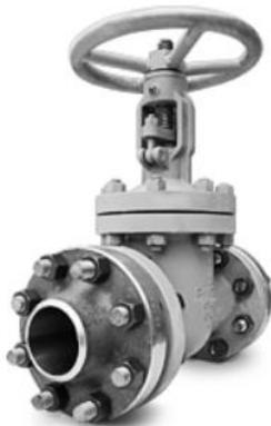
Стальные клиновые задвижки предназначены для установки на трубопроводах в качестве запорного устройства. Корпусные детали задвижек изготавливаются из стали марок: 35Л, 20ГЛ, 12Х18Н9ТЛ, с фланцевым присоединением и под приварку, с ручным управлением (с маховиком, механическим редуктором) или исполнением под электропривод. Класс герметичности «А» по ГОСТ 9544-2005. Срок службы не менее 10 лет. Гарантия 24 месяца.
